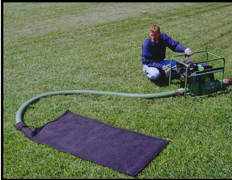
Dewatering sediment bag.
